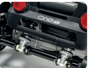
Les amortisseurs sur les roues et la suspension au bas du siège procurent une sensation de conduite plus agréable.
